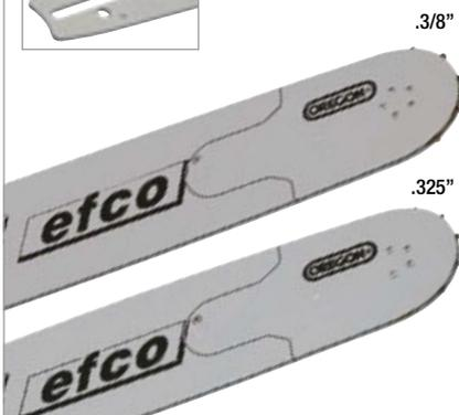
**Les guides pleins avec embout à rochet remplaçable**, conçus pour des applications professionnelles, sont équipés d'un système de lubrification efficace (Lubrijet®), grâce à un conduit incliné sur le guide qui est maintenu propre par le passage des mailles d'entraînement de la chaîne. L'embout remplaçable est disponible pour les chaînes d'un pas de .325" et de .3/8".
