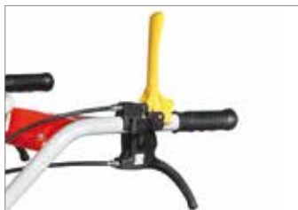
Alavanca no guiador para engate das mudanças.
