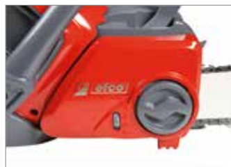
Regulação da corrente sem ferramentas.
