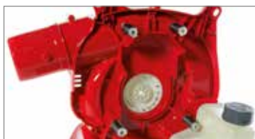
Sistema anti-vibratório profissional "VibCut", montado em 4 molas amortecedoras em aço: isolamento total do utilizador das vibrações.
