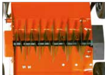
Ротор, состоящий из 15 стационарных ножей.
