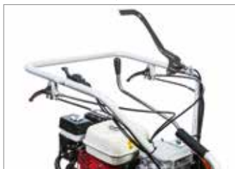
Рулевое управление с независимым управлением разблокираторами и тормозами.
