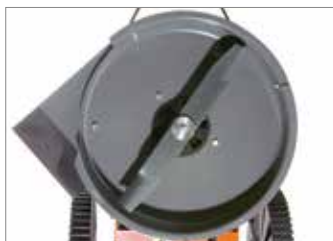
Прочный боковой разгрузочный канал из стали.
