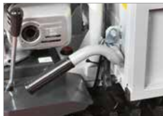
Ручное опрокидывание с автоматической системой блокировки.
