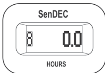
Licznik godzin pracy silnika*** Wyświetla liczbę godzin pracy silnika
