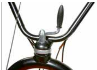
Guiador regulável na vertical e na horizontal através da respetiva alavanca no guiador.
