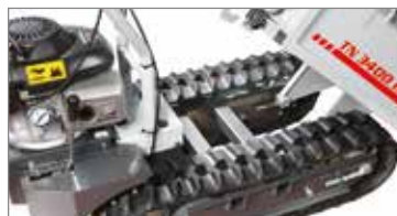
Chassis robusto com estrutura em aço. O baixo centro de gravidade fornece uma ótima estabilidade durante o trabalho, mesmo em terrenos inclinados. A posição alta do motor e da transmissão torna a manutenção muito cómoda.
