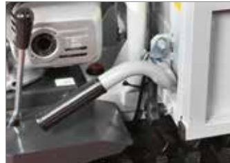
Basculamiento manual con sistema de bloqueo automático.
