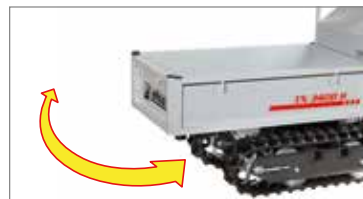
Radio de giro reducido para moverse fácilmente en obradores, invernaderos y viñedos.
