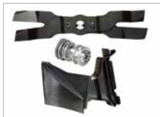
Kit mulching opcional (cuchilla + cubo portacuchilla + tapón): tritura la hierba en partículas muy pequeñas que se depositan en el suelo, dejando un corte limpio y siempre uniforme.
