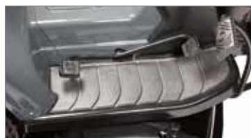
Nouvelles tondeuses autoportées à éjection latérale à vitesse réglée à travers une double pédale agissant directement sur la transmission hydrostatique. Cette solution permet de varier le sens de marche et de mieux contrôler la vitesse durant l'emploi.
