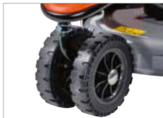
Double roue frontale avec blocage pour assurer stabilité et résistance sur les terrains irréguliers.
