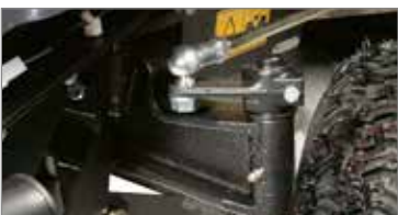
Essieu AV obtenu par une fusion d'acier pour résister aux conditions les plus critiques et aux chocs éventuels.
