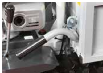
Basculamiento manual con sistema de bloqueo automático.
