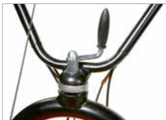
Manillar dotado de palanca para la regulación vertical y horizontal.
