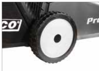
Ruedas de aluminio de gran diámetro (208 mm las delanteras y 235 mm las traseras) con rodamientos de bolas y bandas de rodadura sustituibles.
