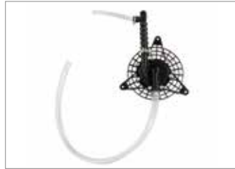
La bomba de empuje o booster mantiene mezclada la solución de líquidos en el depósito y, al mismo tiempo, aumenta y estabiliza el caudal de salida del producto. Para AT 900/AT 9000 se ofrece también la versión "llenado", que permite cargar el depósito sin quitarse la máquina de la espalda.
