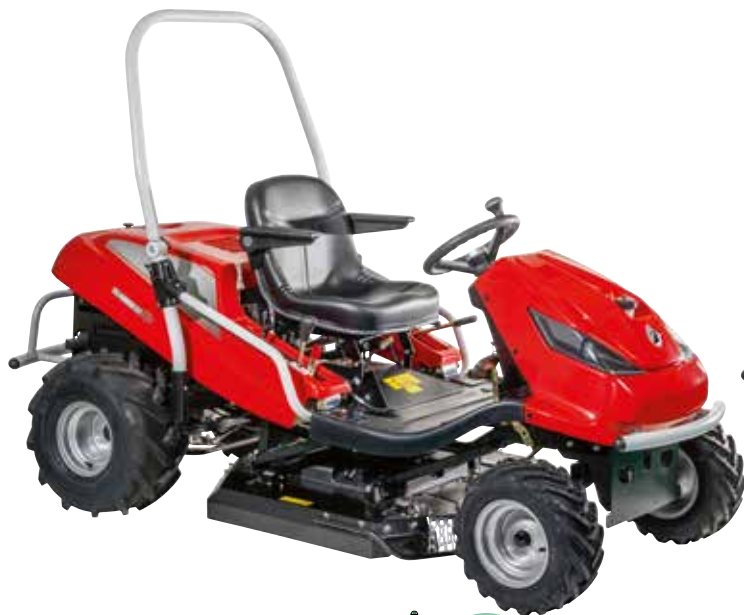
Las bandas de rodadura anchas y el centro de gravedad bajo aseguran la máxima estabilidad en terrenos accidentados o en proximidad de orillas y cunetas.
