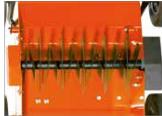
Rotor compuesto por 15 cuchillas fijas.
