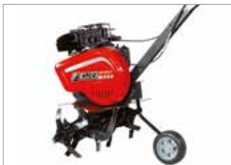
Rueda trasera para transportar la máquina.
