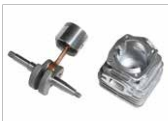
Pistón con 2 segmentos elásticos, eje y biela de acero forjado y mecanizado, jaulas de rodillos, cilindro cromado: rendimiento constante a lo largo del tiempo incluso en uso exigente.
