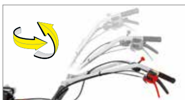
Los brazos se regulan en todas las posiciones: en altura para adaptarlos a la estatura del operador, y lateralmente para poder marchar a un lado del cultivo sin pisarlo.
