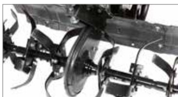
El cárter reforzado de la transmisión protege la máquina de piedras y choques accidentales.
