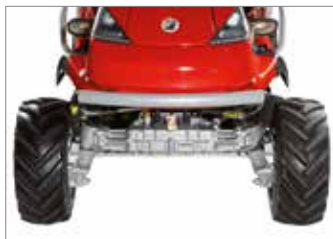
Las bandas de rodadura anchas y el centro de gravedad bajo aseguran la máxima estabilidad en terrenos accidentados o en proximidad de orillas y cunetas.
