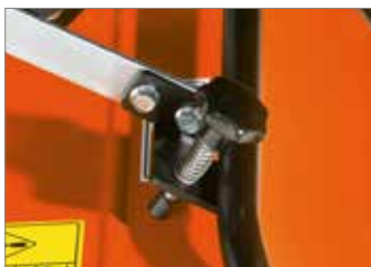
Muelle de regulación de la profundidad de trabajo. Garantiza el mantenimiento constante de la posición preestablecida.
