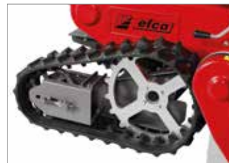
Sistema de tracción con correas, oscilante sobre el plano vertical (modelo 100 TR ).
