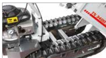
Bastidor robusto con estructura de acero. El centro de gravedad bajo proporciona una óptima estabilidad incluso en superficies inclinadas. La posición elevada del motor y de la transmisión hace más cómodo el mantenimiento.
