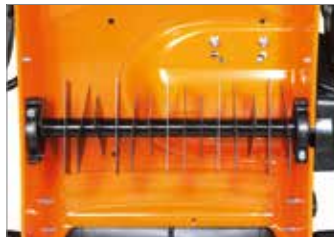
Rotor compuesto por 15 cuchillas fijas.
