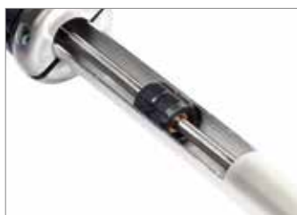
Varilla de transmisión rígida, Ø 8 mm: alta fiabilidad gracias al eje de transmisión rígido que se desliza sobre 6 rodamientos autolubricantes.
