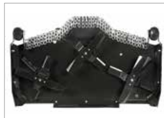
Plato de 110 cm dotado de 3 rotores con 6 cuchillas mulching, para desmenuzar finamente todo tipo de césped y arbustos ( TONKAWA ).
